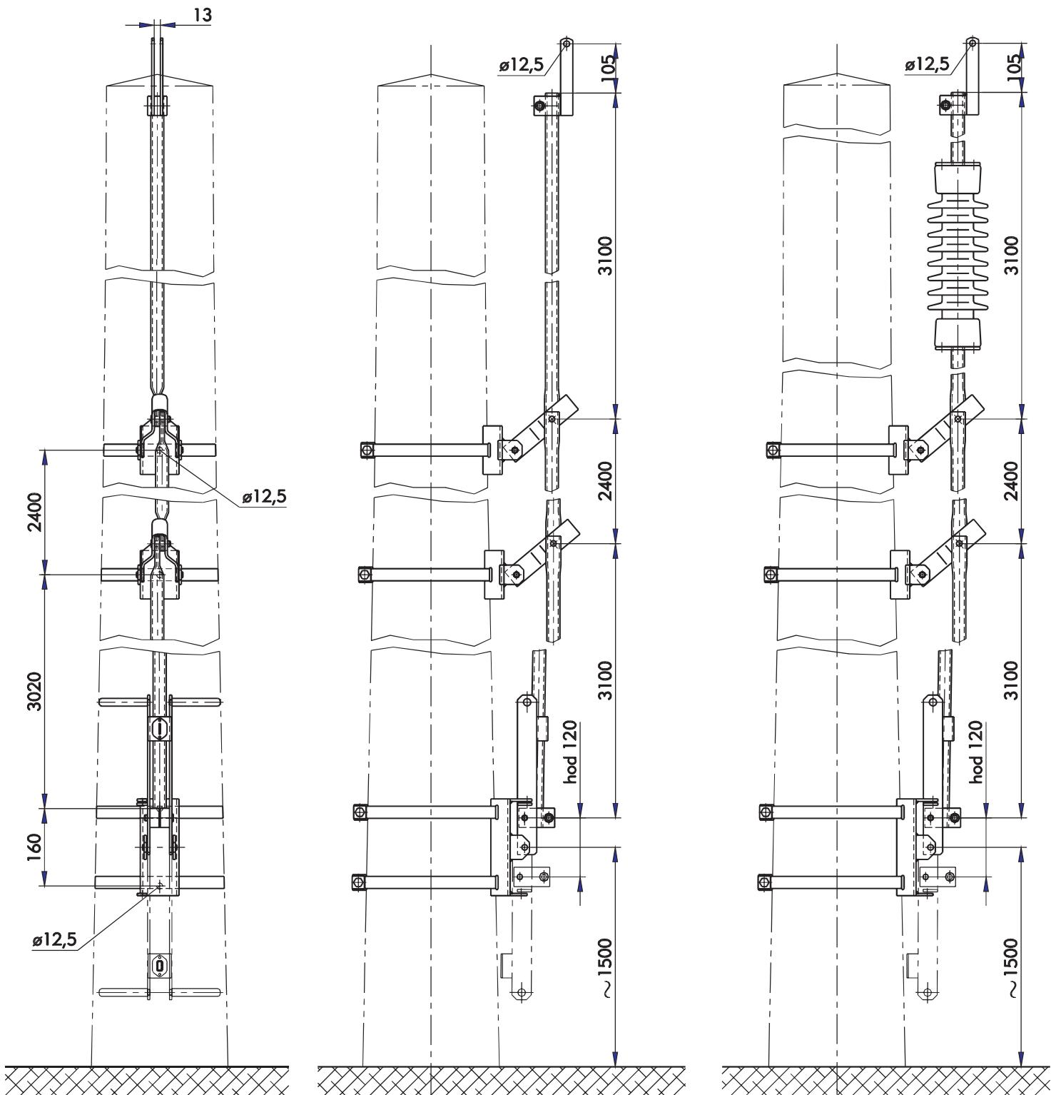
RPZ v izvedbah brez in z izolatorjem za 24 kV, pritrjen s pritrdilnimi trakovi
